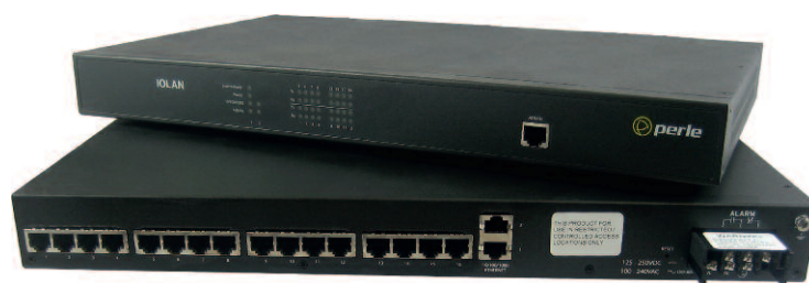
Рис. 3. Сервер последовательных интерфейсов МЭК61850-3 IOLAN SDS16C HV
